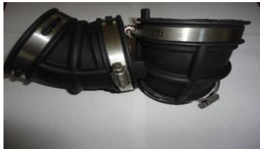
Ilustración 1 Ductos de cuerpo de aceleración
